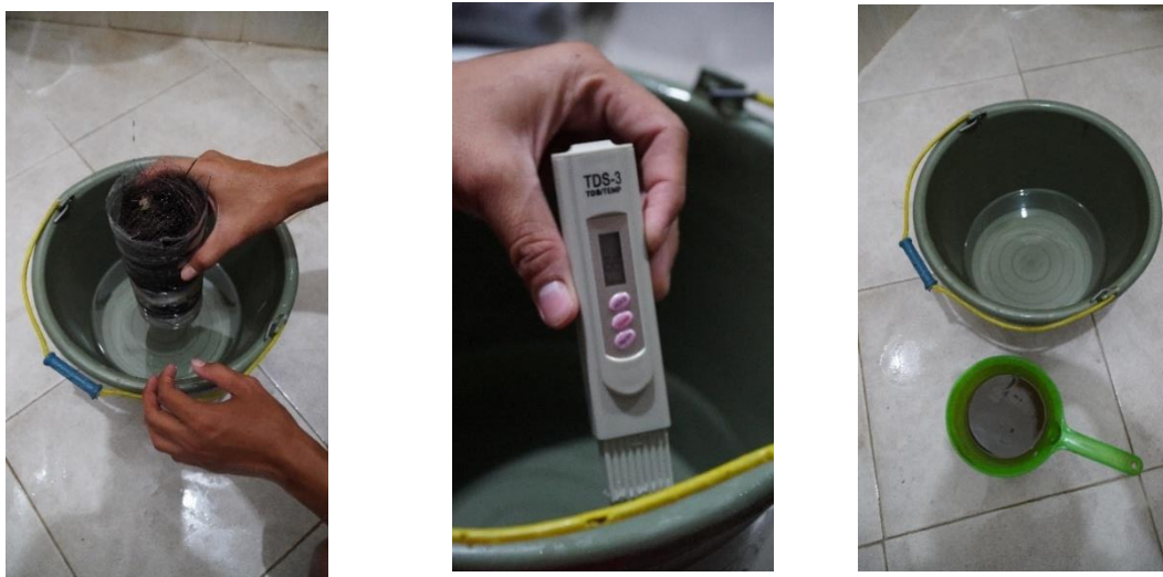
Gambar 4. Pengukuran kualitas air dengan menggunakan TDS Meter dan perbandingan air yang sudah tersaring dengan air kotor (belum tersaring)
