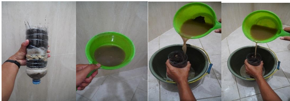
Gambar 3. Penuangan Air Kotor ke Filtrasi Sederhana yang Sudah Dirancang
