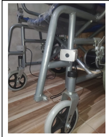
Gambar 3.3 Posisi Pemasangan Sensor Ultrasonik Sumber : dikelola oleh penulis (2025)
