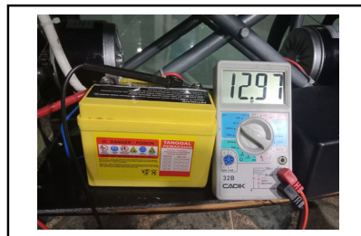
Gambar 3.8 Pengujian Baterai atau Aki
