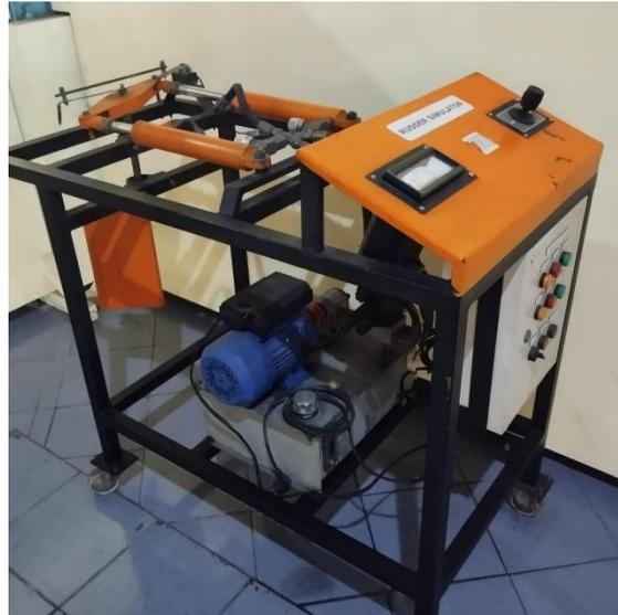
Gambar 1.3 Alat Instruksi Sistem Hidrolik Kemudi Kapal
